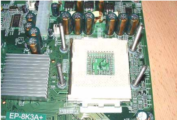
Abbildung 3 – Vorderseite der Platine mit eingesetzten Schrauben
