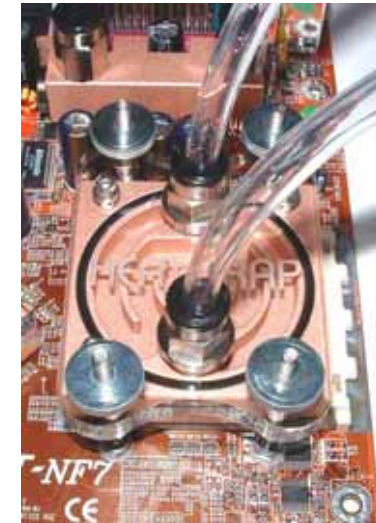
Abbildung 6 – Fertig installierter Kühler
