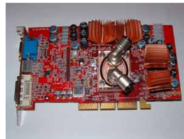
Abbildung 7 – Fertig installierter Kühler
