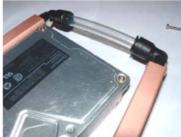
Abbildung 6 – Fertig installierter Kühler
